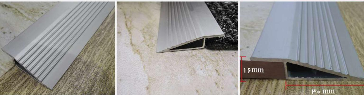
پروفیل شیبدار مثلثی به نوعی طراحی وس اخته شده است که میتواند اختلاف ارتفاع بین دو سطح را بدون پاگیر بودن رفع بکند اغلب مشکلاتی مانند گیر کردن پا و خطر افتادن فرد در محل هایی که اختلاف بین موکت یا پارکت و کاشی و بلعکس دارند وجود دارد که با استفاده از این پروفیل میتوان این مشکل را حل نمود این پروفیل ها در دو ارتفاع ۸ و ۱۶ میلیمتر تولید میشود
