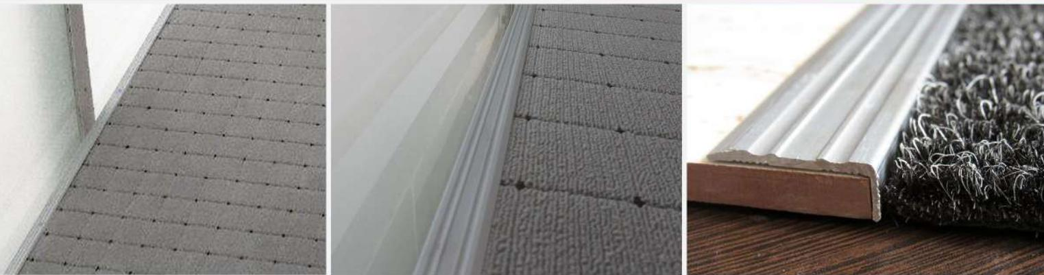
پروفیل آلومنیومی نبشی دور با کاربری های مختلف با شکل نبشی و با عرض ۳ سانتی متر و لبه ۱ سانتی متر میباشد جنس این پروفیل ها نیز از آلومنیوم ۶۰۶۳ ایرالکو و آنودایز نقره ای میباشد.
