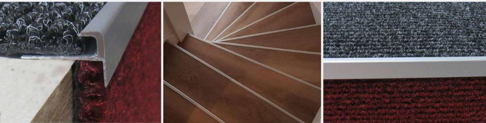
پروفیل آلمینیومی عصایی برای استفاده در لبه‌های پله که با موکت و یا پارکت تمام می‌شود مورد استفاده قرار می‌گیرد. جنس این پروفیل‌ها از آلمینیوم ۶۰۶۳ می‌باشد. ایرالکو بوده و رنگ آن نیز آنودایز نقره‌ای می‌باشد.
