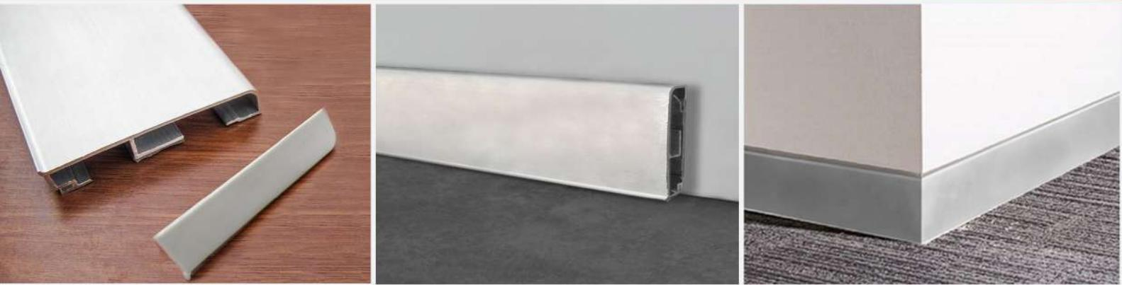
قرنیز آلومینومی با تجمع خواص قرنیز آلومینیومی و داکت قسمت جدا نمودن انواع کابل‌ها و سیم‌کشی‌ها طراحی شده که دسترسی سریع و آسان به سیم‌کشی را برای شما فاهم می‌کند با نصب ساپورت یا پایه نگه دارنده با پیچ و رول پلاک به دیوار می‌توان قرنیز را به صورت کشوی روی آن نصب کرد این قرنیز بیشتر در دفاتر و ادارات و همچنین مدارس و دانشگاه‌ها و فضاهای تجاری مورد استفاده قرار می‌گیرد.
