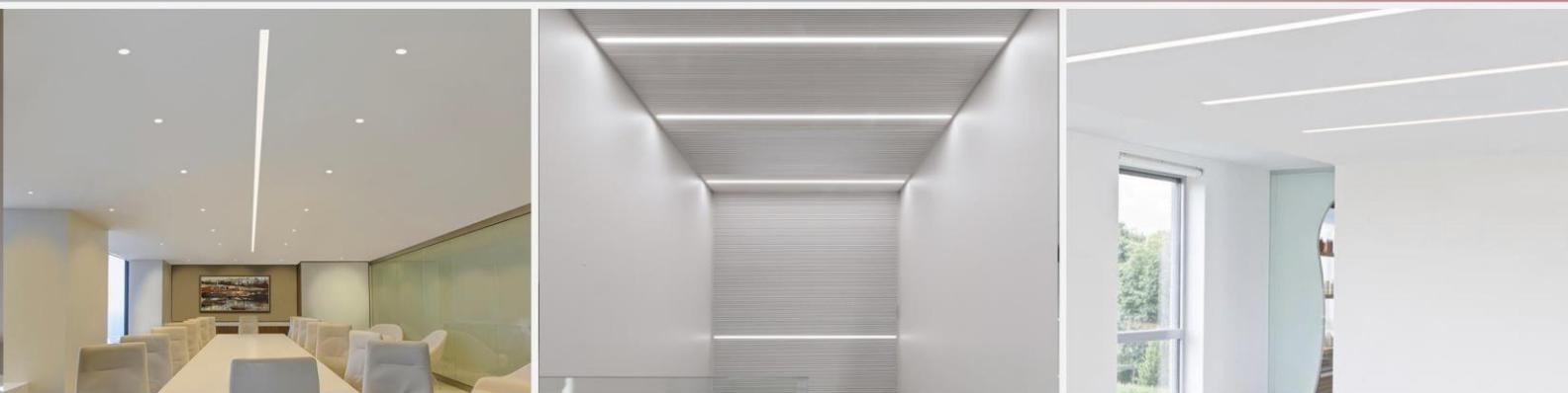
این مدل اغلب در سقف‌های کاذب متداول مانند کناف اجرا می‌شود این مدل هم به عنوان تأمین‌کننده نور اصلی محیط و هم به عنوان نورخطی دکوراتیو استفاده قرار می‌گیرد. چراغ‌های خطی کناف نیازی به ایجاد حفره و برش در سقف ندارند و به صورت روکار روی دیوار یا سقف محیط‌های مختلف نصب می‌شوند. پس اگر شما قصد نورپردازی در فضایی را دارید که سقف‌های آن از قبل اجرا شده است، بهترین گزینه استفاده از چراغ‌های خطی کناف است.
